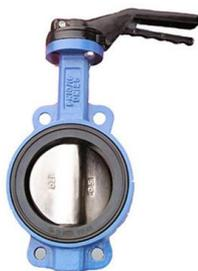
Дроссельная заслонка - это клапан, который можно использовать для перекрытия или регулирования потока. Механизм закрытия имеет форму диска. Работа аналогична шаровому крану, что позволяет быстро отключаться. Обычно предпочтение отдается поворотным дисковым затворам, поскольку они дешевле по сравнению с клапанами других конструкций, а также имеют меньший вес, а это означает, что требуется меньше опоры.
